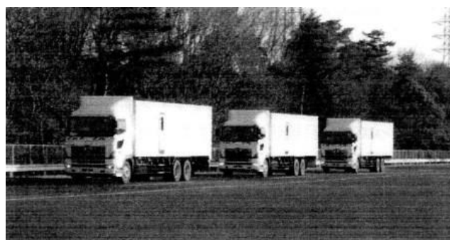
80km/h 車間距離 6m での隊列走行試験
